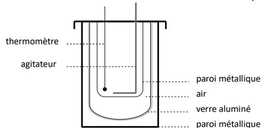
Capacité thermique du calorimètre à vase Dewar utilisé vaut :  $C_{\text{calo}} = 61,4 \text{ J}\cdot\text{K}^{-1}$
