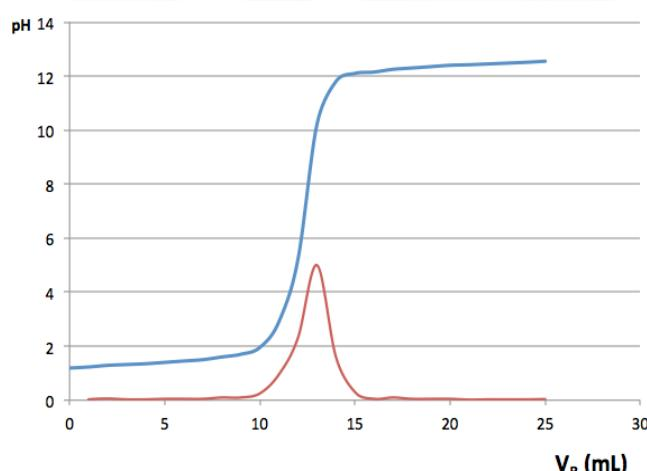
**CAPEXO 17.** Le graphe ci-dessous représente l'évolution du pH de la solution titrée en fonction du volume de solution titrante versé lors d'un titrage. Déterminer le volume à l'équivalence par 2 méthodes différentes.
