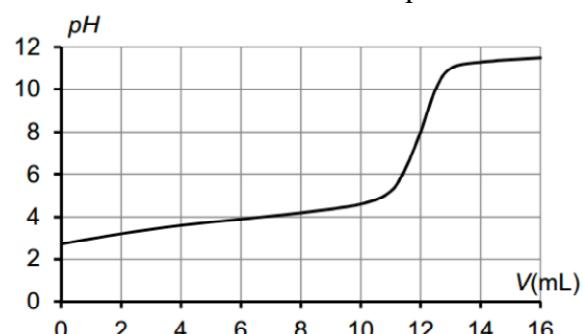
**CAPEXO 12.** Le graphe ci-dessous représente l'évolution du pH de la solution titrée en fonction du volume de solution titrante versé lors d'un titrage. A l'aide d'une construction graphique, déterminer le volume à l'équivalence.
