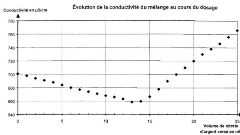
**CAPEXO 15.** Le graphe ci-dessous représente l'évolution de la conductivité de la solution titrée en fonction du volume de solution titrante versé lors d'un titrage. A l'aide d'une construction graphique, déterminer le volume à l'équivalence.
