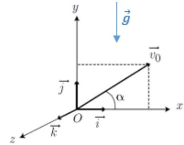
**Définition d'une chute libre :** Modèle d'un mouvement d'un système uniquement soumis à son poids.
