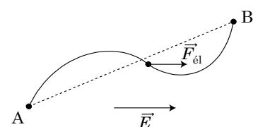
Pour un champ électrostatique constant, le produit scalaire  $\vec{E} \cdot \vec{AB}$  est appelé **tension électrique  $U_{AB}$**  entre les points A et B. D'où, finalement :  $W_{AB}(\vec{F}_{el}) = q \times U_{AB}$
