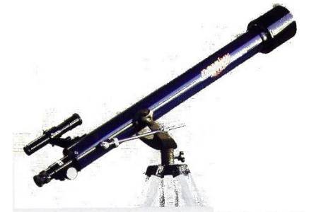
Doc. 4. Lunette astronomique Ø60/800 mm (diamètre et focale) livrée avec 3 oculaires. Grossissements de 40x, 64x et 133x.
