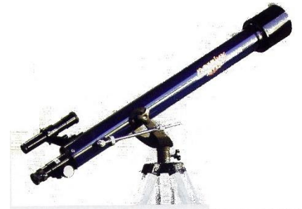
Doc. 4. Lunette astronomique \varnothing 60/800 mm (diamètre et focale) livrée avec 3 oculaires. Grossissements de 40 \times , 64 \times et 133 \times .
