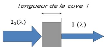
Les appareils de spectroscopie UV-visible et infrarouge mesurent l'intensité lumineuse incidente  $I_0$  et l'intensité lumineuse  $I$  qui a été transmise par un échantillon.
