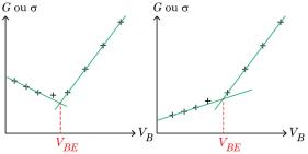
On observe une rupture de pente à l'équivalence. Pour repérer le volume versé à l'équivalence, on trace deux segments de droites et on détermine  $V_E$  à l'intersection des deux droites
