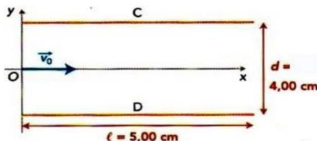
Le vecteur accélération est selon Oy. Comme la particule de charge positive (2 neutrons et deux proton) est déviée vers le haut, alors l'accélération est vers le haut, de norme  $2eE/m$  où m est la masse de la particule (2e est sa charge car 2 protons), soit encore  $2eU/(dm)$ .
