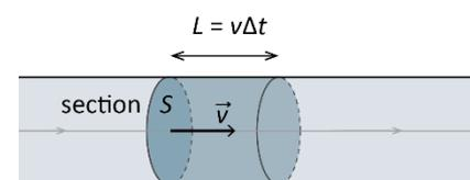
$V$  : volume traversant une section du conduit pendant  $\Delta t$
